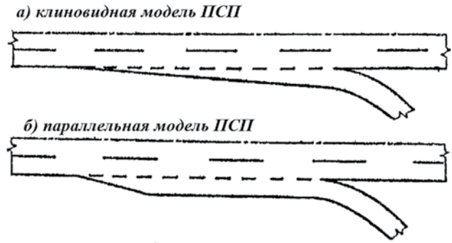
Рис. 7. Типы ПСП съездов транспортных развязок [3, рис. 78]
